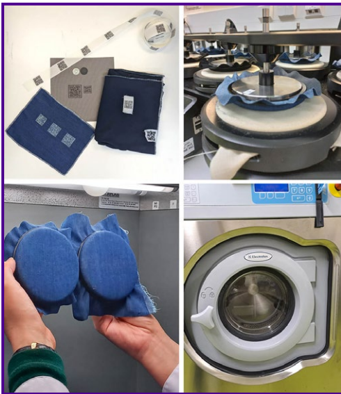
Kuva 4. QR-koodeja eri valmistustekniikoilla toteutettuna kankaille ja nauhoille sekä NFC-tageja. Toimivuutta kokeiltiin nypyyntymis- ja pesutestien jälkeen. Nypyyntymisen testauslaite, näytteen hankaus villakangasta vasten, koepalojen visuaalinen arviointi.
